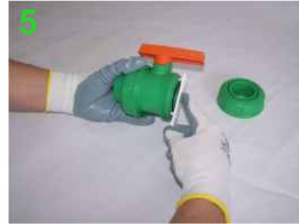
5 Kapalı pozisyonda küre diğer taraftan itilerek çıkartılır. Küre contaları yuvalarında çıkartılır. Sökme ve onarım sonrasında, montaj için işlemleri tersten uygulayın After disassembly and repair, do operations in reverse for assembly
