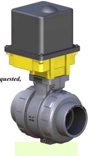
U-P.V.C. Küresel Asit Vanası U-P.V.C. Acid Ball Valve Dişli / Female Thread Küre Contası / Seals : TEFLON O-Ringler / O-Rings : EPDM
