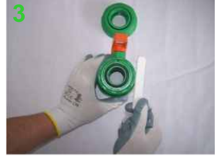
3 Sap kapağı çıkıntıları dayamadaki iki yuvaya yerleştirilir Lid of handle notches are inserted into two seats on ball lean
