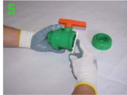
5 Sökme ve onarım sonrasında, montaj için işlemleri tersten uygulayın After disassembly and repair, do operations in reverse for assembly
