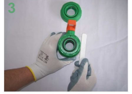
Sap kapağı çıkıntıları dayamadaki iki yuvaya yerleştirilir Lid of handle notches are inserted into two seats on ball lean
