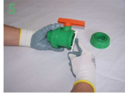
Kapalı pozisyonda küre diğer taraftan itilerek çıkartılır. Küre contaları yuvalarında çıkartılır. Sökme ve onarım sonrasında, montaj için işlemleri tersten uygulayın After disassembly and repair, do operations in reverse for assembly
